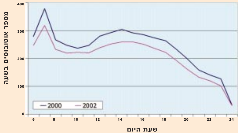
תרשים 5: נפחי התנועה במרכז ירושלים - לפני (שנת 2000) ואחרי (שנת 2002) שינוי מערך הקווים.
